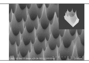
Figure: exemple de surfaces bioinspirées anti-réfléchissantes (Silicium). Structures réalisées par combinaison d'une étape de masquage par auto-organisation et transfert par gravure plasma (Design et images UTT/L2n).
